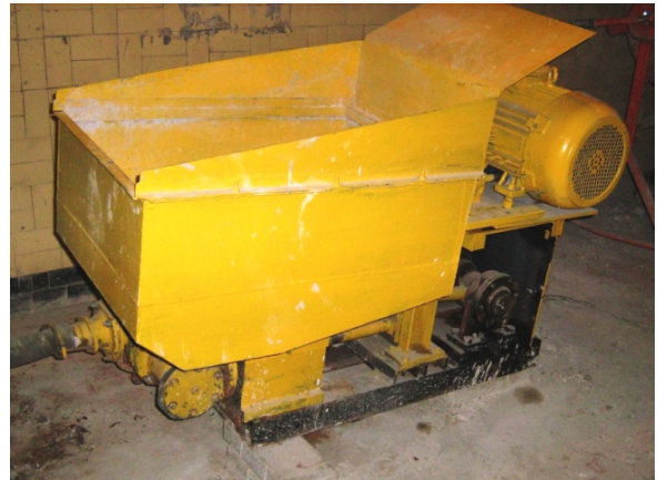
Рис. 11. Двухпоршневой растворобетонасос с тарельчатыми клапанами и горизонтальным расположением цилиндров
