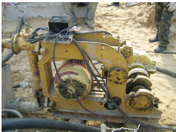
Рис. 8. Противоточный двухпоршневой растворобетоннасос с шаровыми клапанами и вертикальной колонкой
