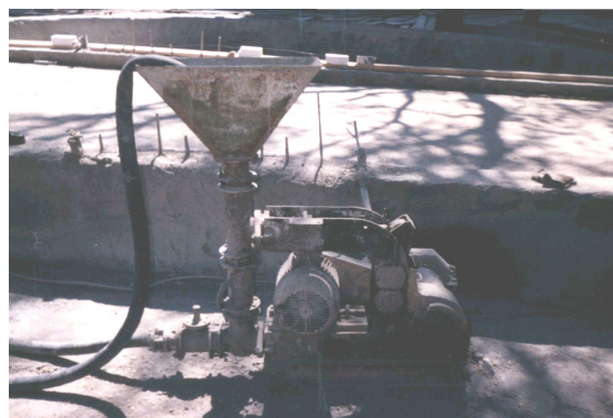
Рис. 9. Прямоточный двухпоршневой растворобетоннасос с конусными подпружиненными клапанами и вертикальной колонкой
