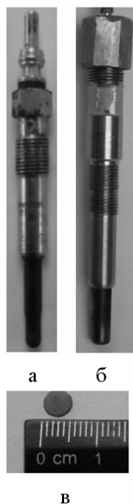
Рис. 1. Штатная свеча накаливания (а), малогабаритный датчик давления (б) и диафрагма (в)
