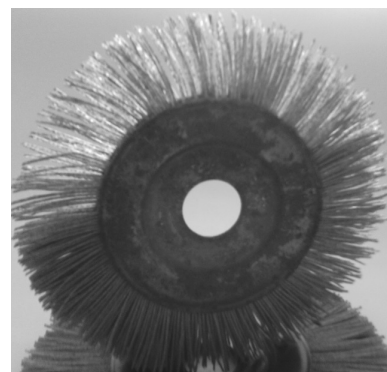
Рис. 3. Полімерно-абразивна щітка, що втратила більшу частину волокон від перегріву
