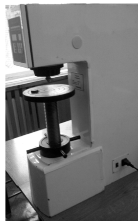
Рис. 2. Прибор Бринелля модели UIT HBW-1
