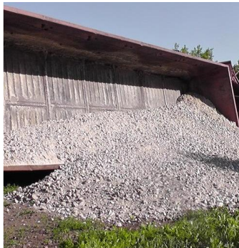
Рис.1. Наслідки перекидання піввагону з насипним вантажем
