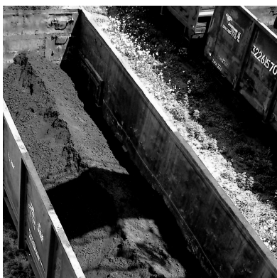
Рис. 2. Нерівномірне розташування насипного вантажу в кузові піввагону
