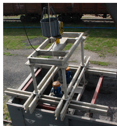
Рис. 7. Пристрій для розрівнювання насипних вантажів у піввагонах системи УкрДУЗТ під час випробувань на станції Вінниця–Вантажна
