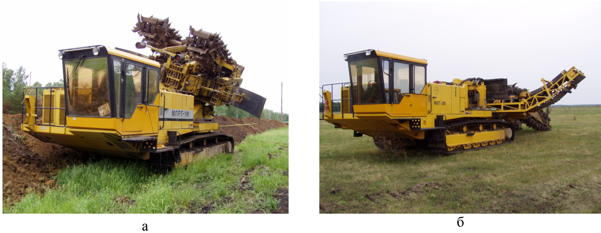
Рис. 1. Машини для капітального ремонту магістральних трубопроводів: а – машина МПРГ-1М; б – машина МВТ-2М
