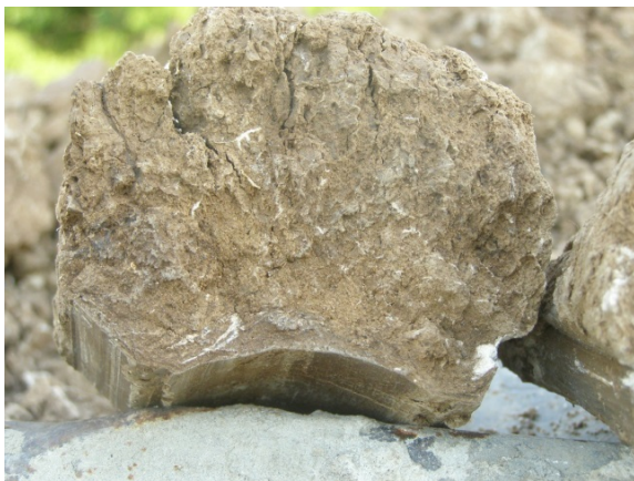
Рис. 4. Фотографии зон массива грунта, на которые оказывалось внешнее воздействие при проколе и расширении скважин
