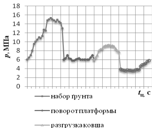
Рис. 2. Циклограмма изменения давления в гидросистеме экскаватора
