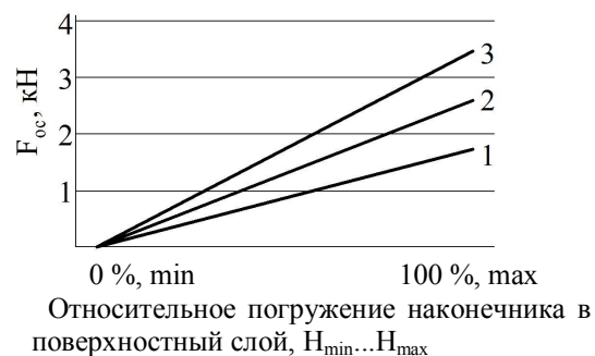
Рис. 4. Зависимости требуемой осевой силы пригруза для внедрения в массив грунта ствола со скошенной головкой и стволом d = 65 мм: 1 – наконечник с углом скоса 30^\circ ; 2 – наконечник с углом скоса 45^\circ ; 3 – наконечник с углом скоса 60^\circ
