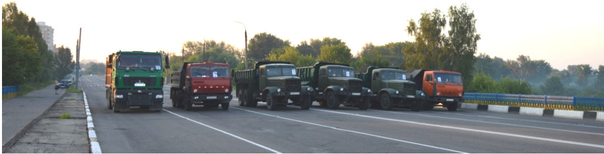
Рис. 3. Установка испытательной нагрузки по схеме 2
