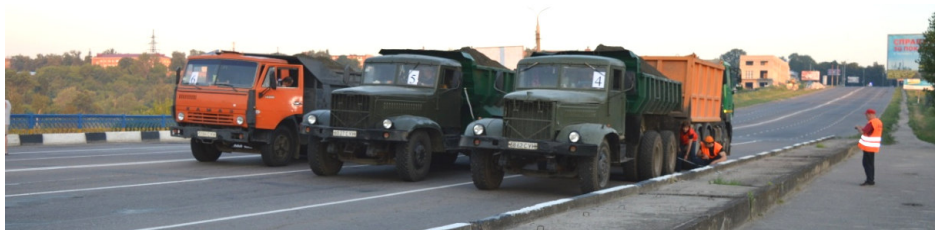
Рис. 2. Установка испытательной нагрузки по схеме 1
