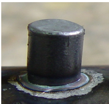
Рис. 2. Фрагменти зварних з'єднань шип (сталь 20) – труба (сталь 15X5M) з характерною утвореною галтеллю
