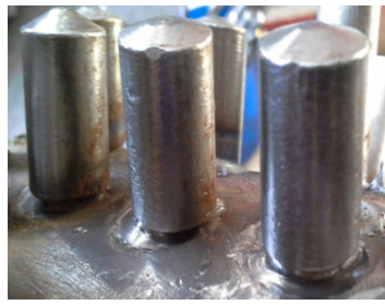
Рис. 3. Фрагменти зварних з'єднань шип (сталь 20) – труба (сталь 15X5M) за умови порушення режимів зварювання: а – формування нещільної галтелі (підріз); б – виплески рідкого металу та нерівномірність формування галтелі
