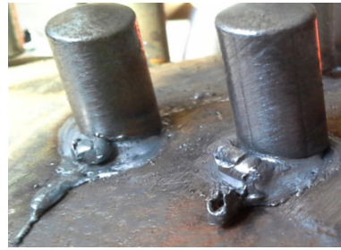
Рис. 3. Фрагменти зварних з'єднань шип (сталь 20) – труба (сталь 15X5M) за умови порушення режимів зварювання: а – формування нещільної галтелі (підріз); б – виплески рідкого металу та нерівномірність формування галтелі
