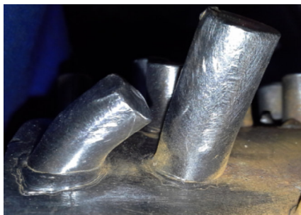
Рис. 4. Фрагменти зварних з'єднань шип (сталь 20) – труба (сталь 15X5M) після проведення динамічного випробування (удару)
