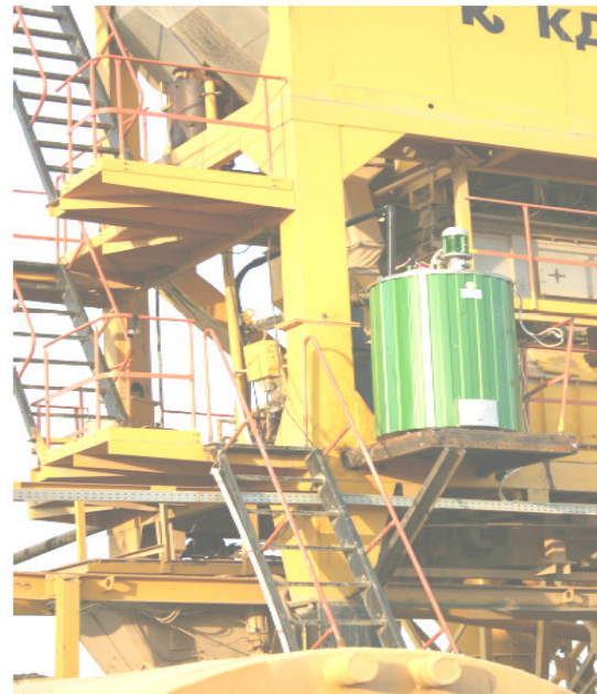
Рис. 4. Внешний вид узла модификатора на асфальтосмесительной установке
