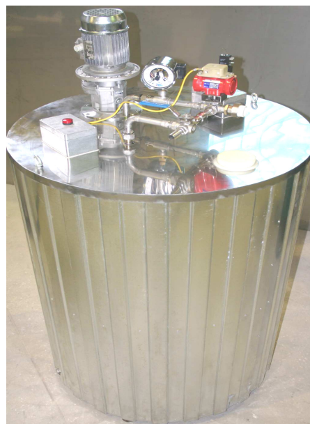
Рис. 1. Гидродинамический смеситель для подачи жидких модификаторов
