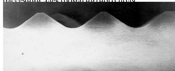
Рис. 3. Макроструктура валика после обработки по 3-му режиму
