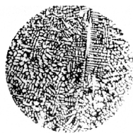
Рис. 1. Структура сплава 150X5Г9Т5С2, \times 350
