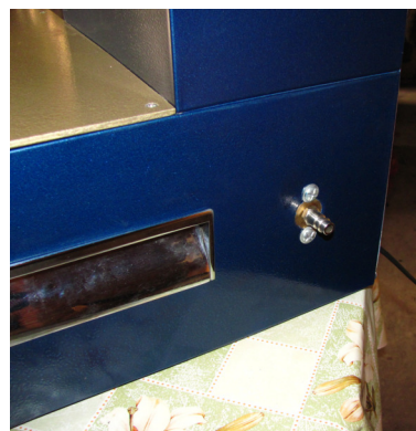
Рис. 4. Подвод рабочего тела к безмоторному стенду от приводного компрессора
