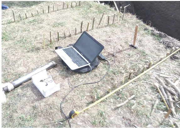
Рис. 6. Условная трасса прокола с шагом измерений в 10 см / Conditional route puncture in increments of 10 measurements in cm
