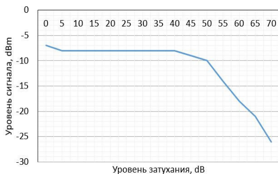
Рис. 9. Уровень принимаемого сигнала в зависимости от вносимого затухания коаксиальной линией / The attenuation level of the signal in a coaxial transmission line with a consistent attenuator connection
