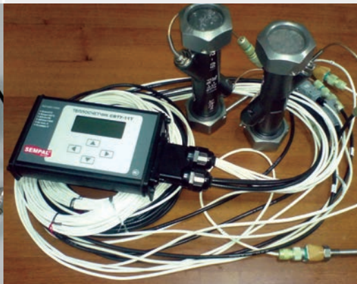
Теплотічильник SVTU-11T виробництва ТОВ фірма «Семпал Ко ЛТД» (м. Київ) у складі теплообчислювача, двох ультразвукових перетворювачів витрати та перетворювачів опору
