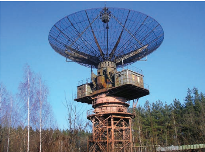
Радар некогерентного розсіювання метрового діапазону з повноповоротною антеною діаметром 25 м (інститут «Іоносфера»)
