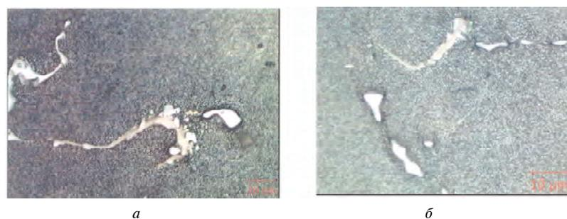
Рис. 8. Зона «залечивания» микропор (а) и рыхлоты (б) в материале отливок лопаток турбины после ГИП,  $\times 1000$
