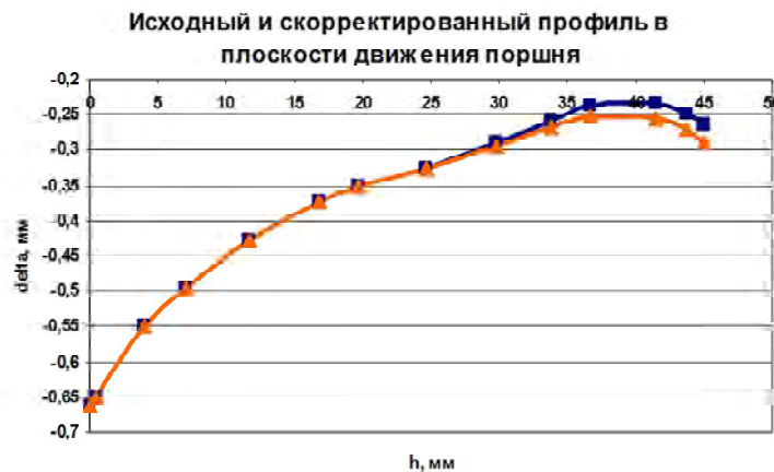
Рис. 10. Продольный исходный и скорректированный профили поршня 11194-1004015МУ (—■— — скорректированный профиль; —▲— — исходный профиль)
