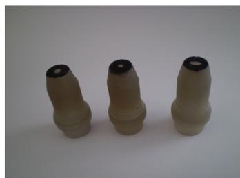
**Рис. 5.** 3D модель (а) устройства для исследования распределения излучения и используемые сопловые насадки (б), полученные методом прототипирования:
