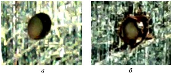
Рис. 8. Отверстие в форме эллипса, полученное при установившемся движении жидкости (а) и полученное при нарушении режима течения (б)
