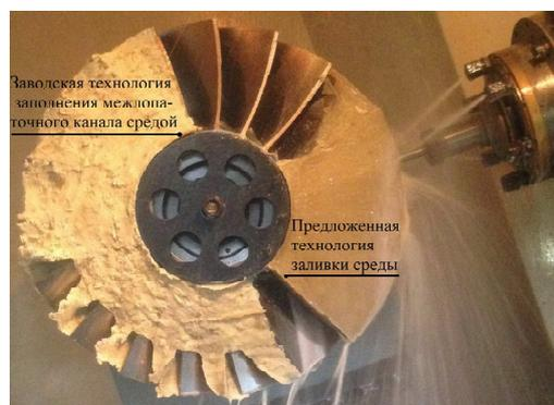
**Рис. 3.** Обработка первого уровня пера лопатки моноколеса ГТД при заполнении межлопаточного канала по технологии заливки
