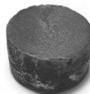
Рис. 1. Зависимость температуры процесса от времени протекания реакции при тепловом самовоспламенении порошковой смеси Ti-Al (а) и общий вид образца алюминидов титана, синтезированного методом СВС (б)
