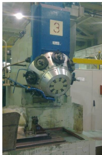
Рис. 12. Станок с ЧПУ ФП-17, оснащенный системой ЧПУ WL-4M
