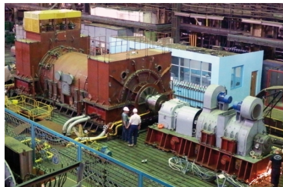
Рис. 5. Випробувальний стенд турбогенератору на стенді заводу ДП «ЗАВОД «ЕЛЕКТРОВАЖМАШ»
