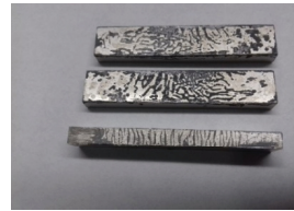
Рис. 12. Поверхность образцов ЮИПМ-NiCr20Ю3 в области пайки при 1300 °С алюминием
