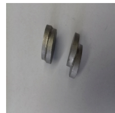
Рис. 14. Паяные образцы нихрома с 20% Cr, 3% Al, 1.5% Y 2 O 3
