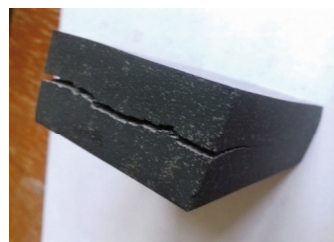
Рис. 3. Вид заготовки, подвергнутой обжатию при прокатке более 10%
