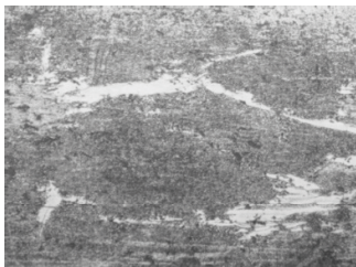
Рис. 15. Микроструктура зоны пайки. Увеличение 1000 X
