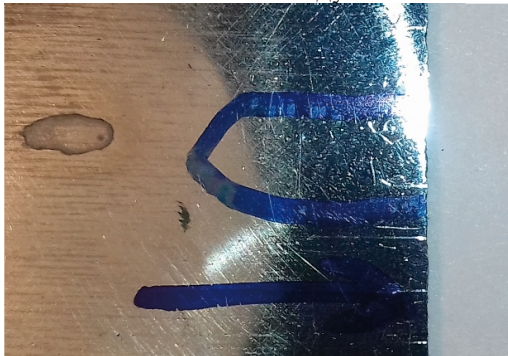
Рис. 2. Зона измерения твердости от основного металла к сварному шву
