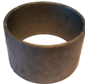
Рис. 7. Фотография молибденового экрана после огневых испытаний
