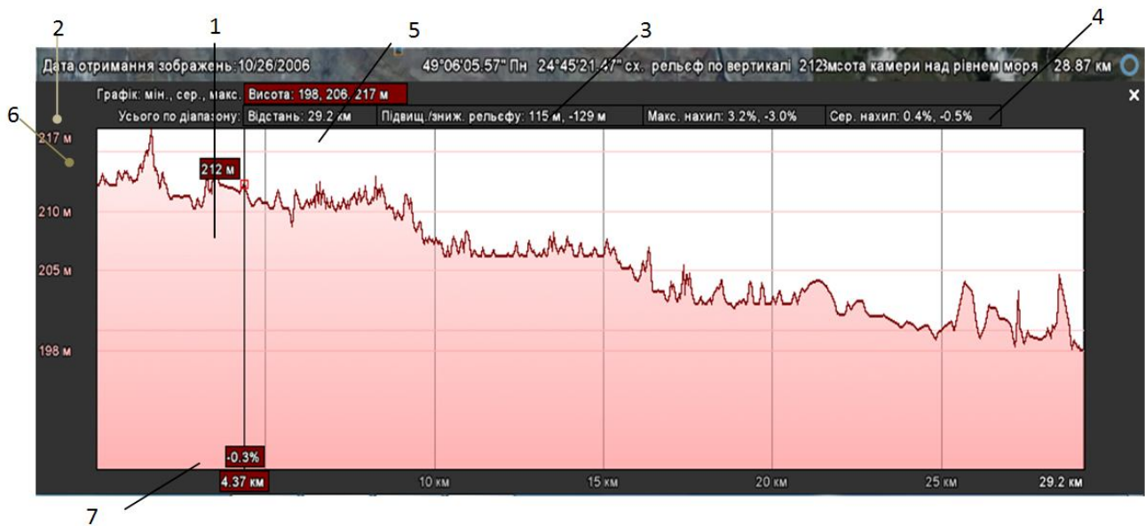
Рис. 2. Приклад безпосередньої побудови вертикального профілю річки вздовж течії.
