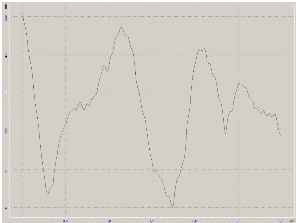
Рис. 3. Профіль поверхні аноду з біоплівкою.
