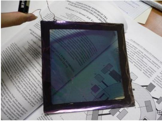
д) Поддача электрического импульса и изменение состояния электролита – переход в первоначальное состояние
