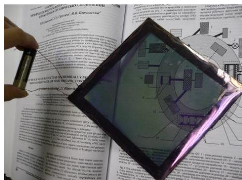
б) Подача электрического импульса и изменение состояния электролита, приобретение синеватой окраски
