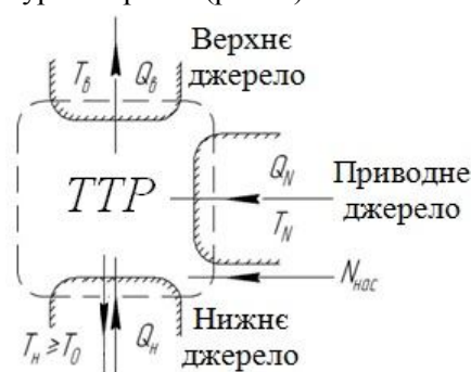
Рис. 1. Схема тепловикористовуючого трансформатора теплоти.
