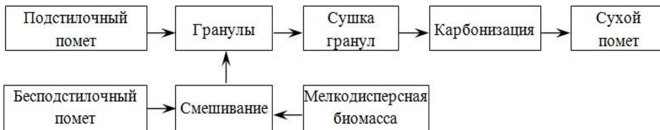
**Рис. 1. Технологическая схема переработки птичьего помета.**
