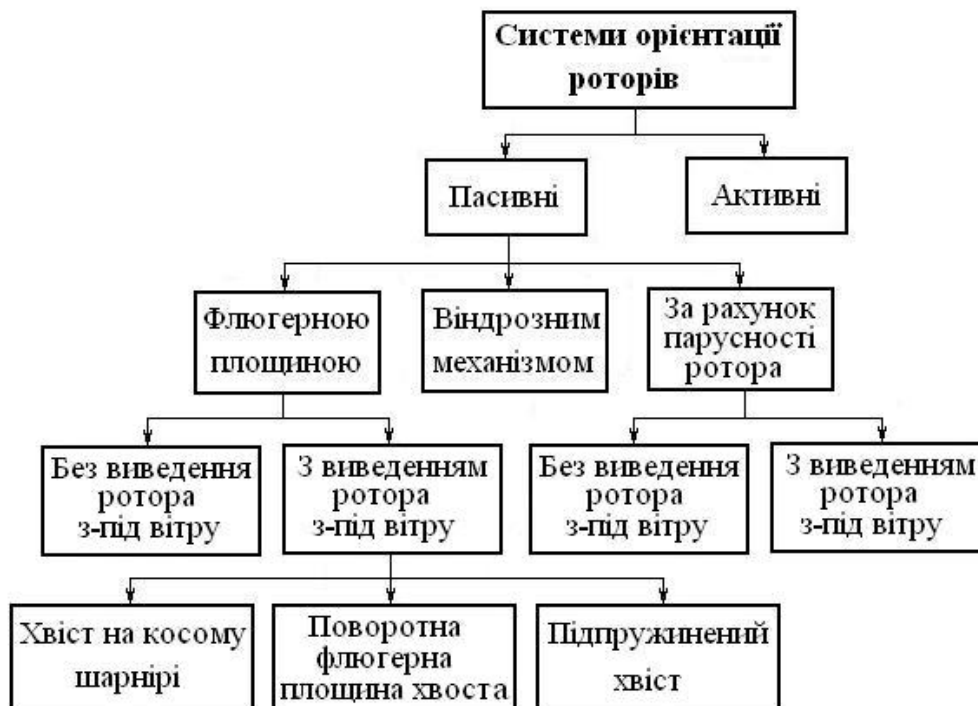
Рис. 1. Загальна схема класифікації систем орієнтації роторів.
