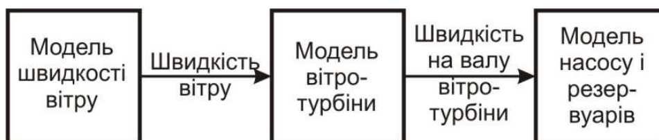
Рис. 1. Структурна схема вітроводонасосної установки.
