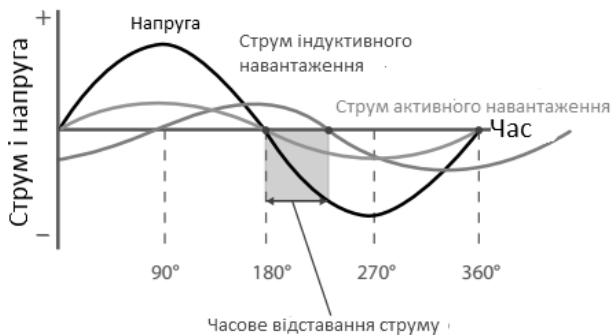
Рис. 1. Проходження струму через індуктивне навантаження Fig. 1. Passage of current through inductive load
