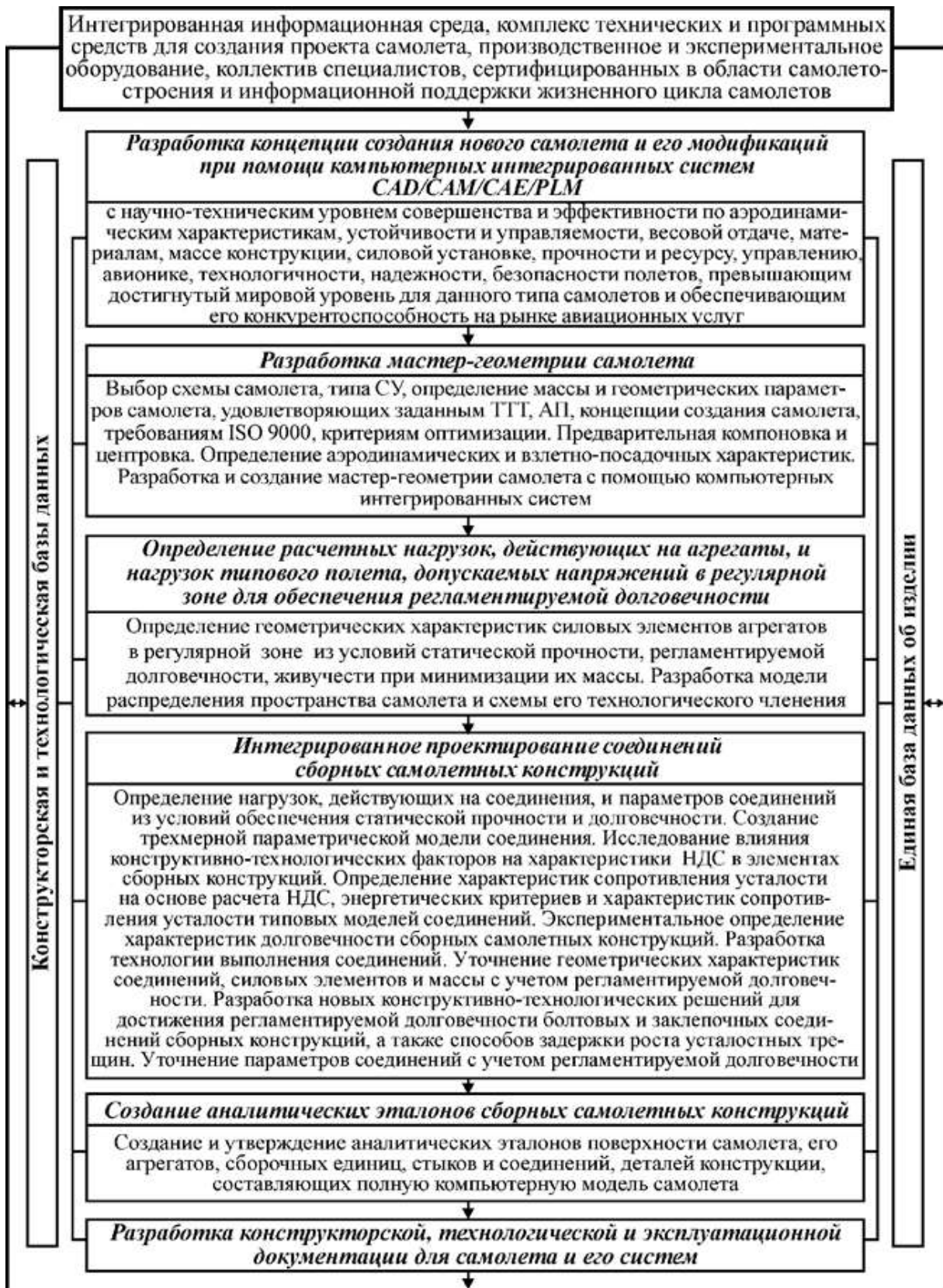
Рис. 3. Нова концепція інтегрованого проектування збірних літакових конструкцій
