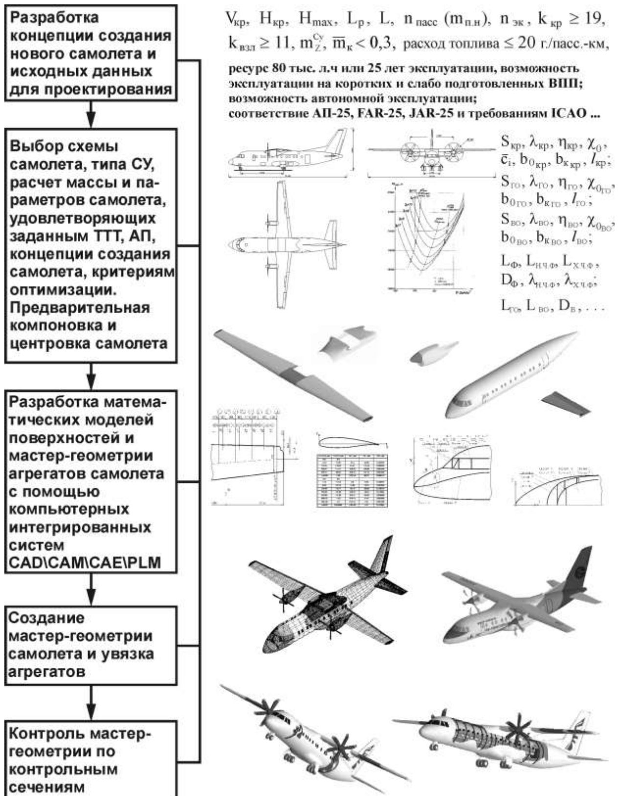
Рис. 4. Метод створення майстер-геометрії літака за допомогою комп'ютерних інтегрованих систем
