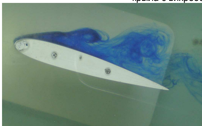
Рис. 9. Динамический отрыв на профиле крыла, исследуемый в гидродинамической трубе
