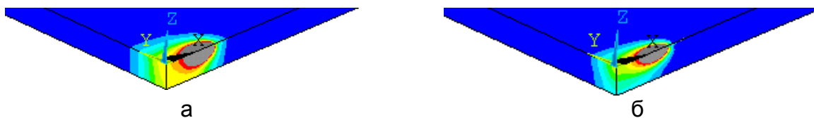
Рис. 8. Результаты моделирования процесса лазерной резки листа из стали 45 толщиной 2 мм при резке с различными скоростями: а – 20 мм/с; б – 50 мм/с
