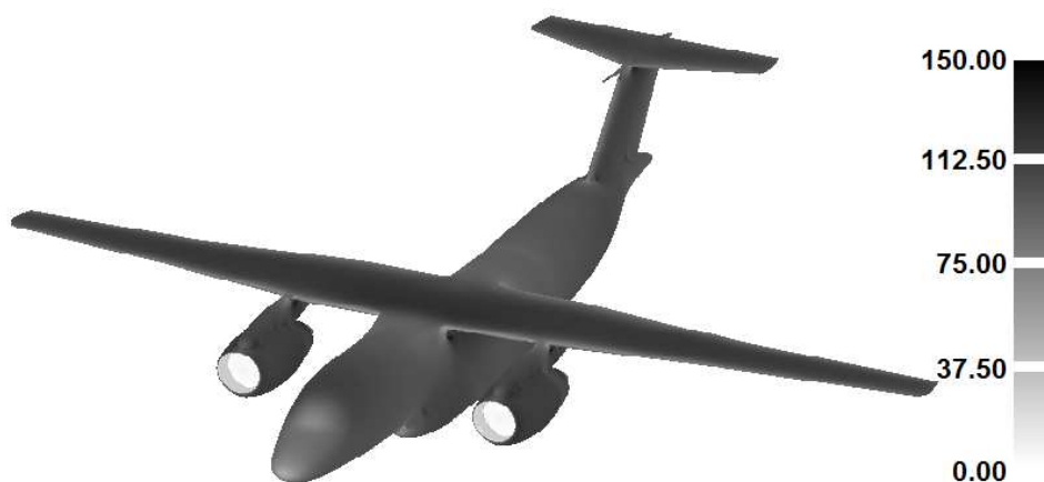
Рис. 13. Распределение модуля скорости вдоль поверхности самолета
