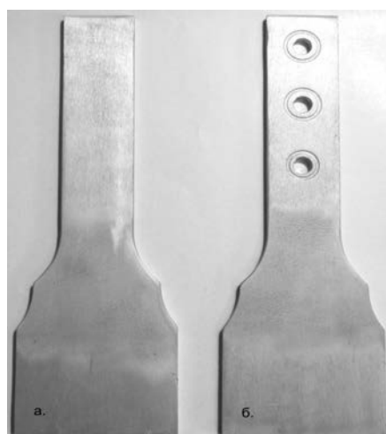
Рис. 12. Заготовки полос: а – гладкая полоса, б – полоса с отверстиями \varnothing 8H7 и обработанная круговым барьерным обжатием
