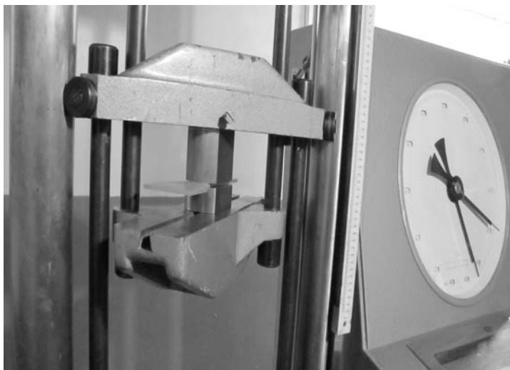
Рис. 14. Установка полосы и обжимок для выполнения кругового барьерного обжата на испытательной машине ZD 10/90
