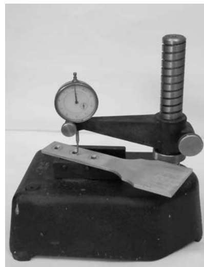
Рис. 15. Контрольно-измерительное приспособление для измерений глубины обжата
