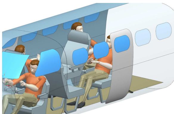
Рис. 5. Фрагмент модели распределения пространства пассажирской кабины самолета Cessna 425 Corsair
