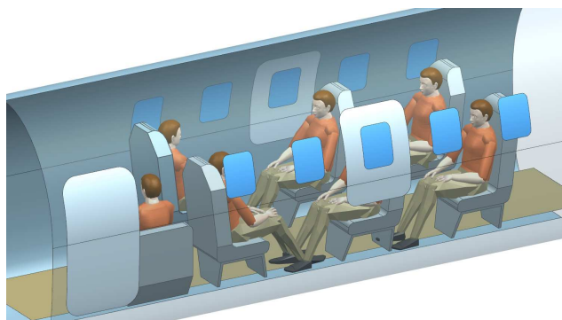
Рис. 27. Фрагмент модели распределения пространства пассажирской кабины самолета Rockwell Sabre 75
