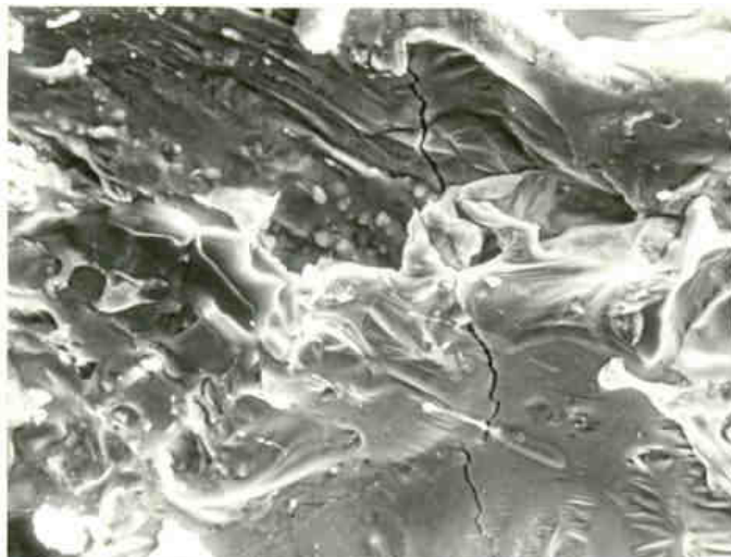
Рис. 1. Наличие трещин на поверхности реза алюминиевого сплава при лазерной резке с кислородом [5]
