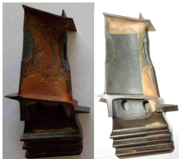
Рис. 5. Следы высокотемпературной коррозии и результат её удаления с поверхности лопатки турбины лазерным методом [12]
