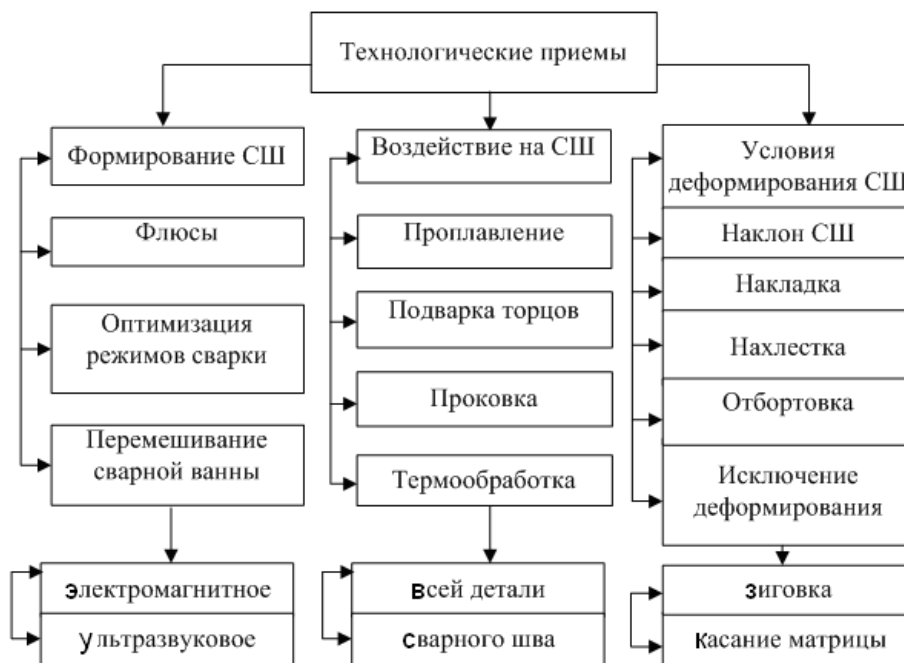
Рис. 2. Блок-схема технологических приемов, повышающих пластические свойства сварных заготовок
