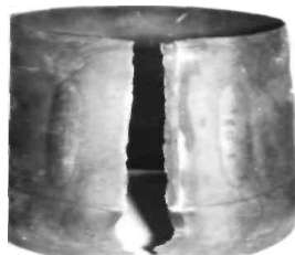
Рис. 3. Заготовка с разрушением в ОШЗ
