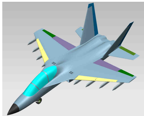
Рис. 12. Фрагмент мастер-геометрии УС с крылом прямой стреловидности
