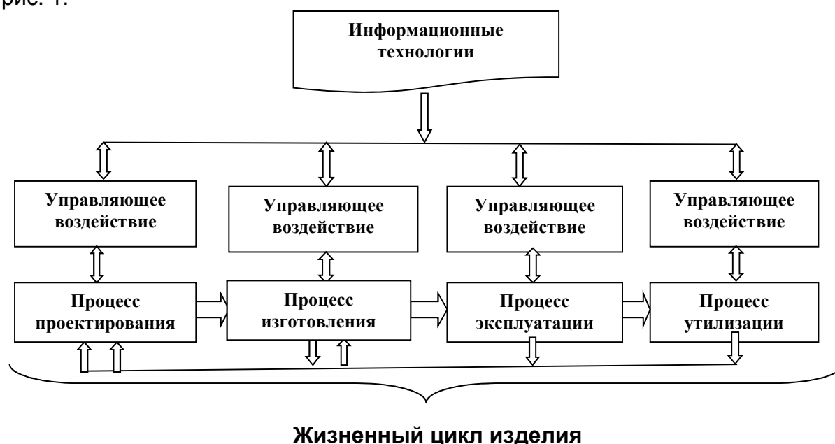
Рис. 1. Общая принципиальная блок-схема CALS-технологии
