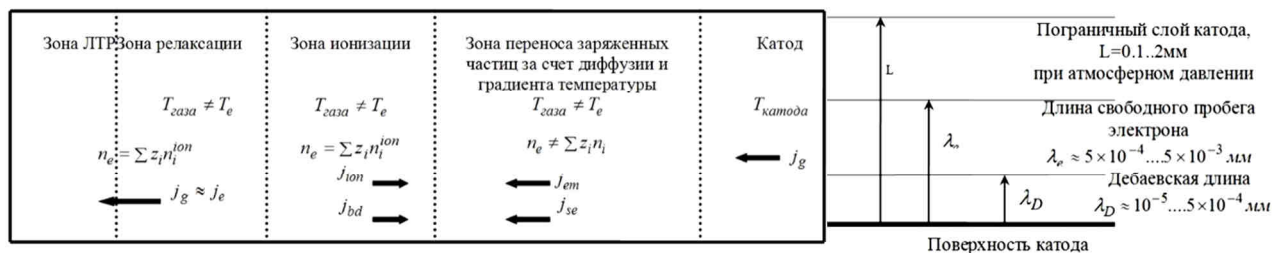
Рис. 7. Структура прикатодного слоя и характерные размеры области
