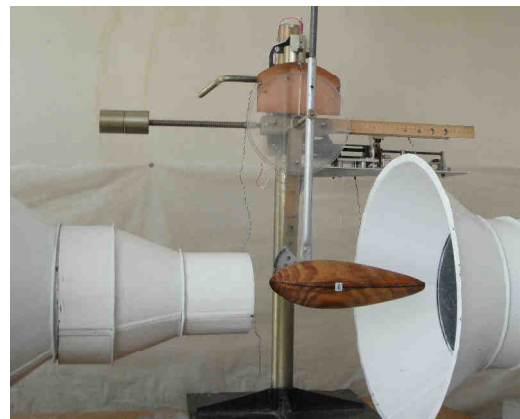
Рис. 8. Измерение подъемной силы и продольного момента
