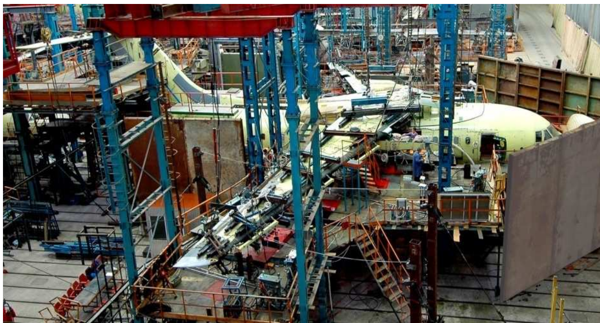
Рисунок 5 – Дослідження планера на міцність
