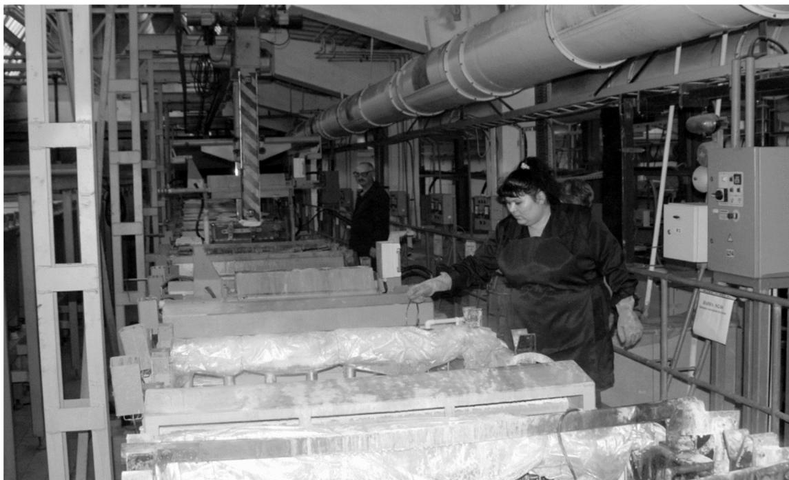
Рисунок 6 – Дільниця гальванічних покрівель деталей літака
