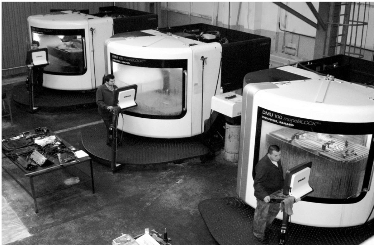
Рисунок 4 – Дільниця 5-координатних фрезерних станків
