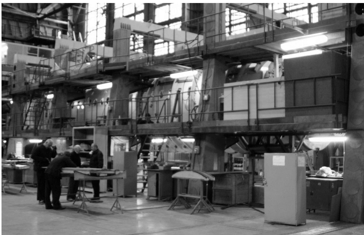
Рисунок 2 – Стапель складання та стикування агрегатів фюзеляжу
